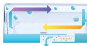
Cikel kroženja zraka pri klasičnih hladilnikih - vlaga se izgublja in živila se sušijo
